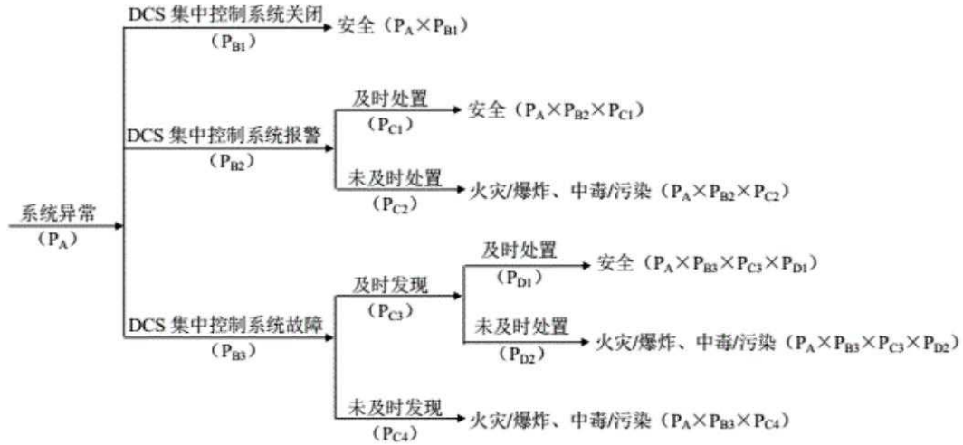
图 11.6-1 生产、贮存系统故障事故树
