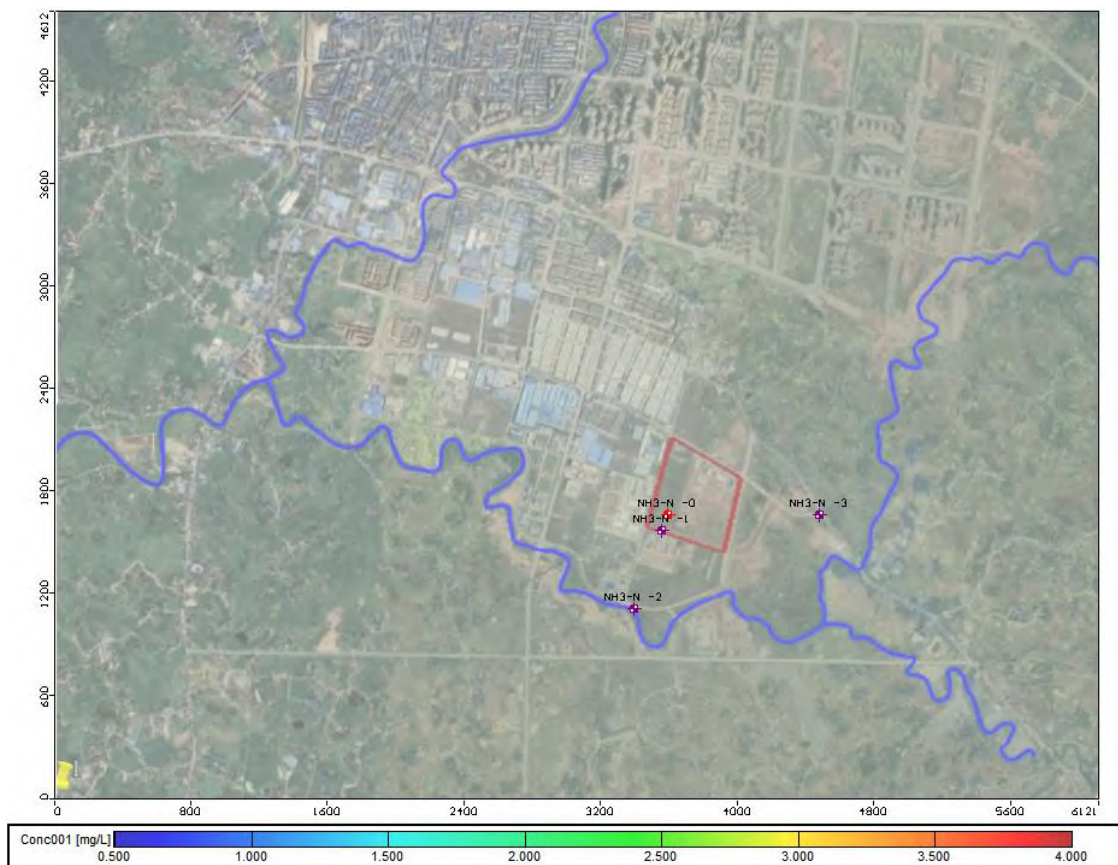
图 10.4-25 \text{NH}_3\text{-N} 泄露后 180d 浓度预测结果
